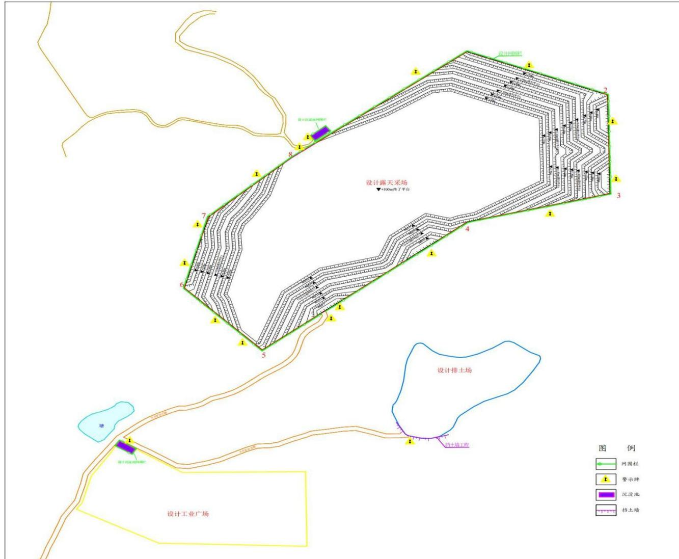
插图 4-19 设计地质灾害隐患消除工程和其他工程部署示意图
